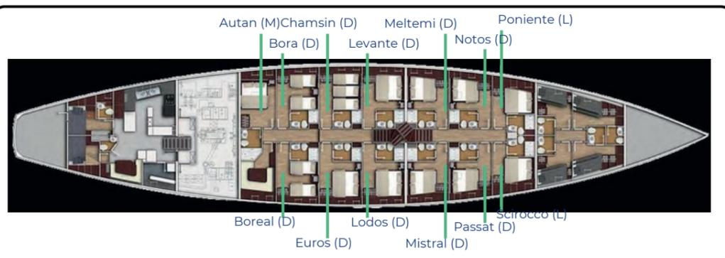
**CHRONOS:** Ketch de Staysail de 54 m con espoleta. Diseñado por Klaus Röder/Tutzing, Alemania y construido en 2013 en Bodrum/Turquía. Casco de acero, acabado en teca y caoba. Amplia zona de cubierta libre, aproximadamente 1.000 sm de superficie vélica, 13 camarotes dobles con baños en suite y aire acondicionado. Los camarotes del CHRONOS llevan el nombre de los vientos. Eslora total: 54 m / max. 26 invitados.
